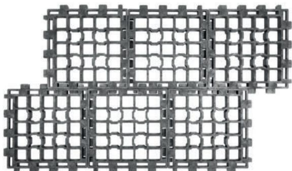
**10mm starke Stege, massive Verzahnungsfinger für schwimmende Verlegung und eine Druckbelastbarkeit von 450 to/m<sup>2</sup> - bei diesem Modell kann man wirklich von „löwenstark“ sprechen.** Mit einer Abmessung von 41x41x4,5cm (LxBxH) und einem Gewicht von ca. 3,8kg/Stück erfolgt die Verlegung rasch (6 Stück/Quadratmeter) und kräfteschonend.
