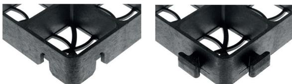
Die Abmessungen von 50x50x5 cm (LxBxH) und das geringe Gewicht von ca. 3,5 kg / Stück sorgen für eine rasche und einfache Verlegung. Durch das Verbundankersystem entsteht eine einzige, große und sicher zusammenhängende Fläche – alle Einzel-Gitter sind darüber fest miteinander verbunden. Durch die spezielle Materialrezeptur ist die Platte deutlich rutschfester als vergleichbare Produkte aus simplem Hartplastik.
